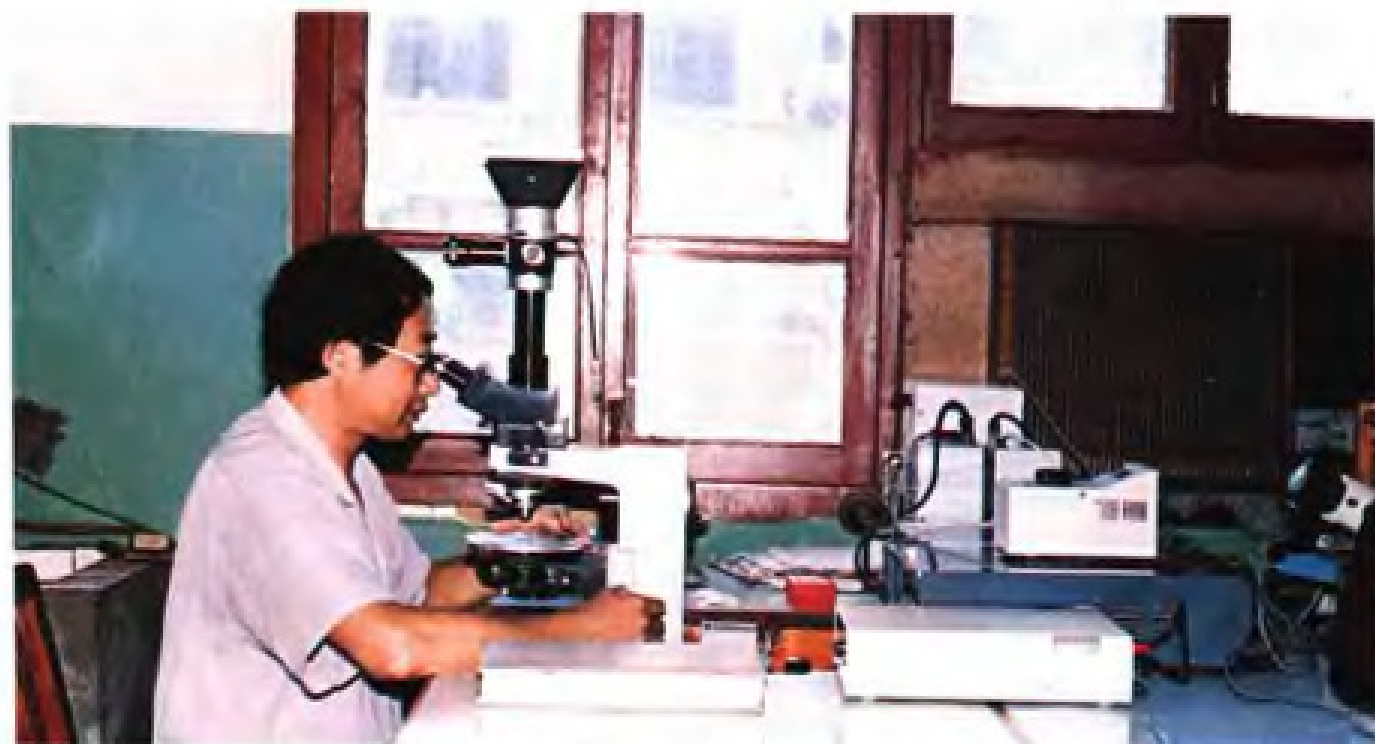
△省地质科学研究所技术人员在测试晶体包裹体
