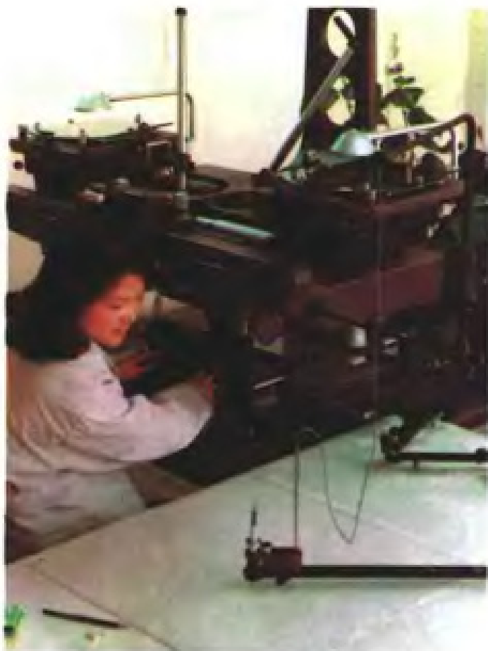
精密立体测图仪在进行航测地形图测绘。
