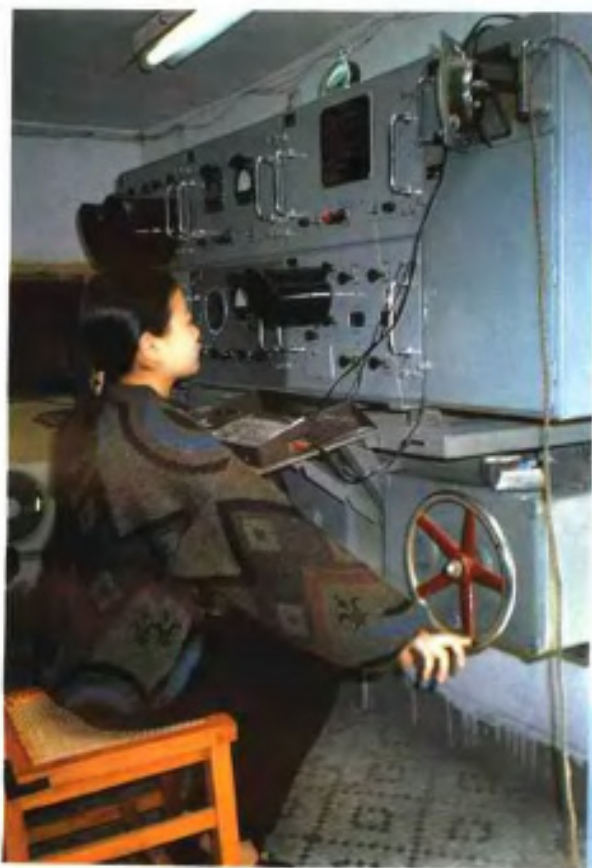
△701 雷达进行高空气象观测
