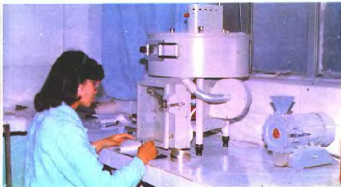
布拉本德快速水份测定仪测试水份
