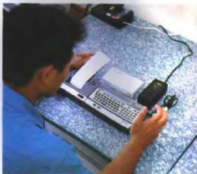
PC 1500 微机粮温检测仪
