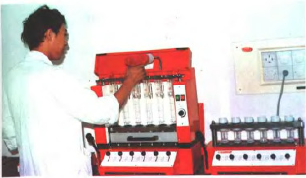
瑞典Tecator 纤维测定仪
