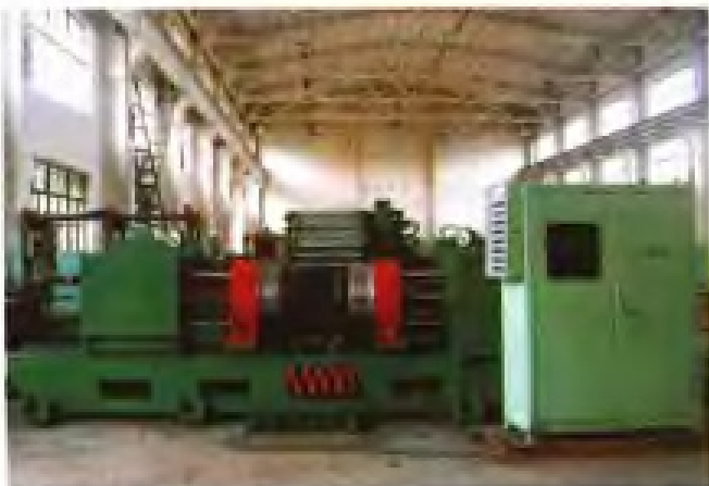
建阳橡胶机械厂生产的 LCY-1 型子午线 轮胎一段成型机组
