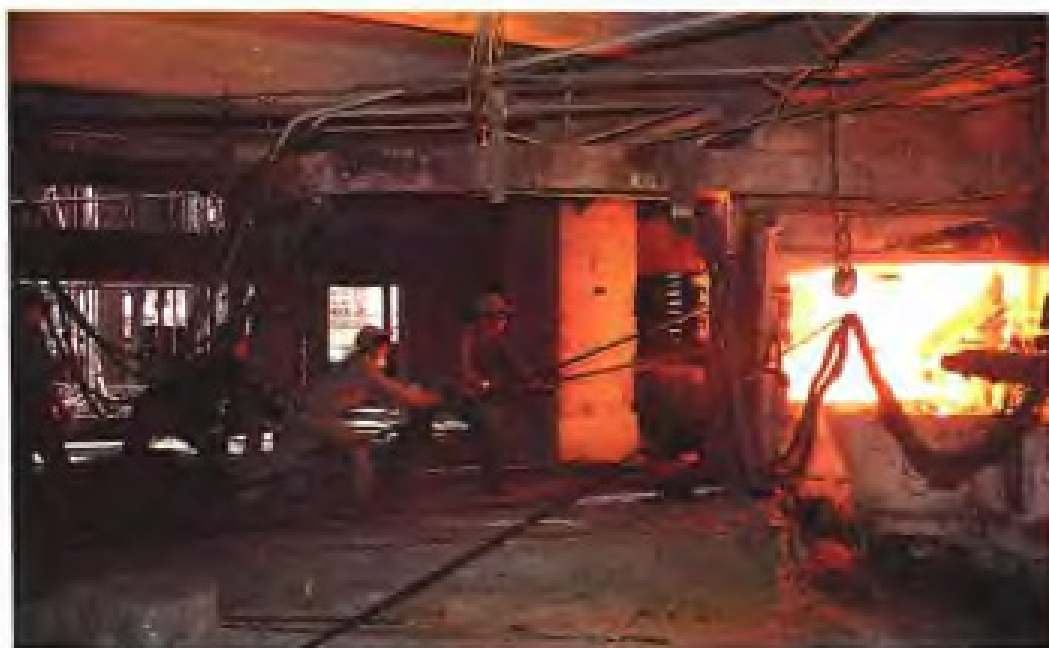
三明化工总厂电石出炉情景
