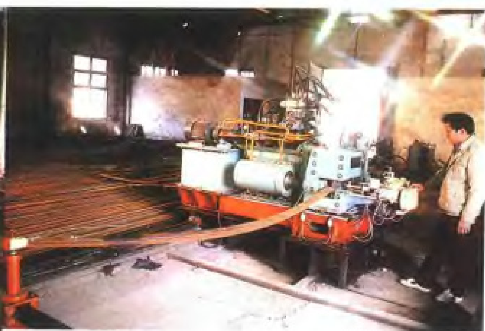
智能型微控肋骨冷弯机
