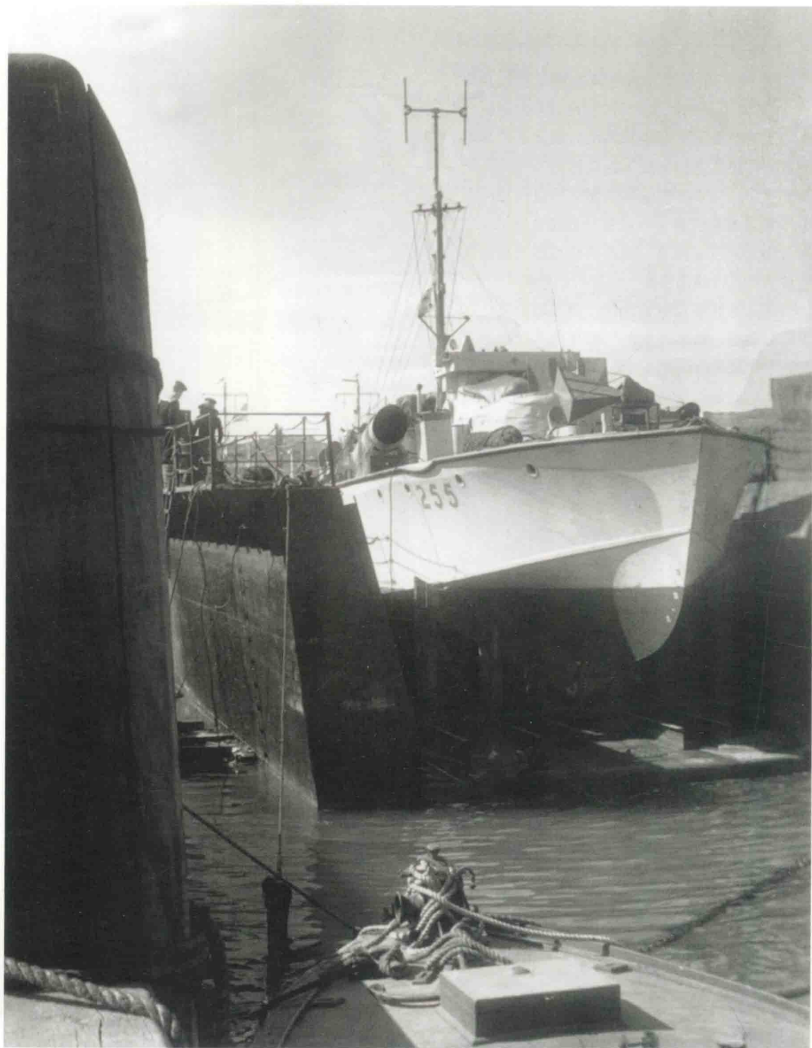
在浮动干船坞中的 MTB 255 鱼雷艇，前甲板上是一部烟囱状的高频天线，在桅杆顶部的是低频偶极天线。该艇于 1945 年 2 月 14 日在奥斯滕特港神秘爆炸，所有船员均丧生。（图片来源：R·G·R·哈加德）
